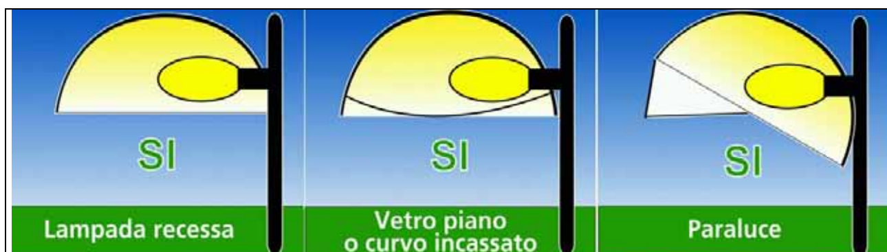
Fig.2 – Apparecchi conformi alla L.r. 17/09.
